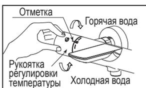
1. Поверните рукоятку регулировки температуры, чтобы установить желаемую температуру на выходе в соответствии с отметкой 40 °C. Отметка «40» представляет собой стандартную температуру воды на выходе.
